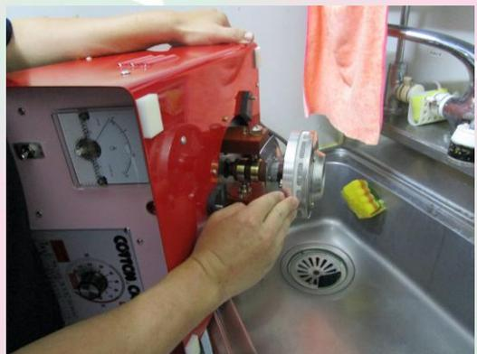
※火傷に気を付けて、回転釜を90度づらし、熱湯をかけ、1周させます
